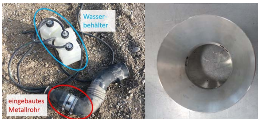
Abbildung I-1: Bestandteile der DROP-NO x -Applikation (li.), Metallrohr mit Querschnittverjüngung (re.)
